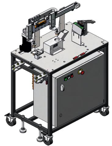
Le poste de contrôle au milieu de la ligne est équipé d'une balance électronique, connectée à l'automate industriel M251. Cette balance permet d'obtenir la masse précise de la capsule de café. Un bac à bec «rouge» permet la réception des capsules non conformes. Les capsules conformes sont envoyées vers le poste de conditionnement (poste C)
