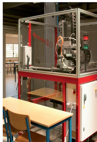
Le manipulateur Ecolmanip est un ensemble de manipulation permettant de saisir et déposer des briquettes ou boîtes en vue d'une mise en carton ou sur palettes.
