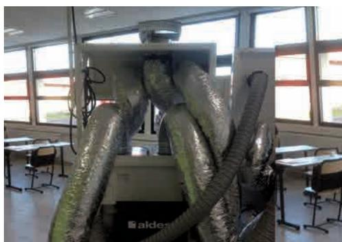
EcolVmc permet la mise en œuvre et l'analyse de deux ventilations simple et double flux hydroréglables à haut rendement, dans le spectre des réglementations thermiques récentes.
