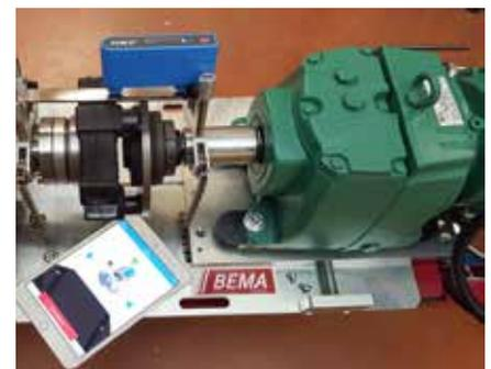
Le «Banc d'alignement d'arbres et poulies» est un sous-système de broyage de déchets plastiques. Il est destiné à servir de support à la pratique des réglages d'alignement de transmission directe ainsi que de transmission indirecte par chaîne. Il est doté d'un réducteur coaxiale, de paliers autoalignateurs, d'un volant de manœuvre à poignée rétractable, d'un accouplement élastique avec limiteur de couple et d'un plateau rotatif permettant les 2 types de transmissions.
