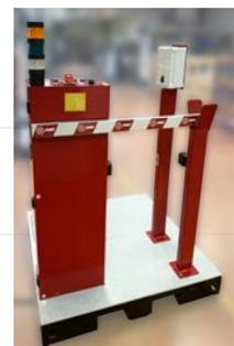
Notre système Barrière de Parking se compose d'un trottoirs de rue avec lève tampon et protection de chambre distincts , de la partie opérative et d'une grille avec automate Schneider M221 ATV31
